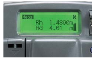
DL-500の場合、スタッフのコードを自動的に読み取り、正確な測定値を即座にデジタル表示。
